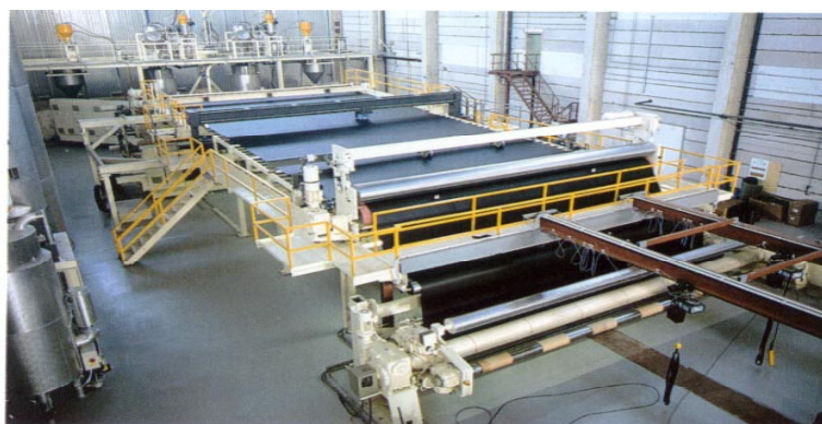
Confección de paños de PEAD.
